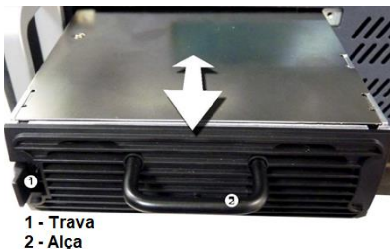
Figura 96 - Acesso à Fonte de Alimentação
