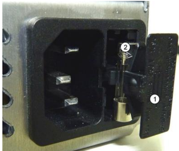
Figura 98 - Entrada do Fusível (1) e Fusível (2)
