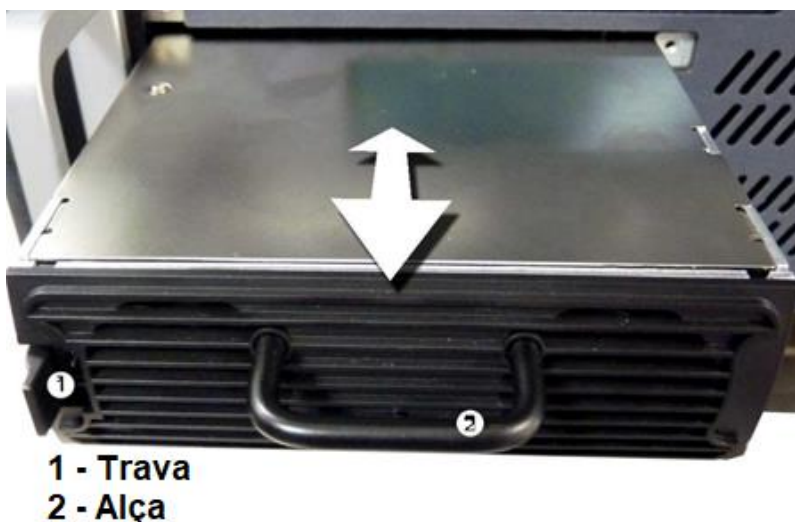
Figura 84 – Acesso à Fonte de Alimentação
