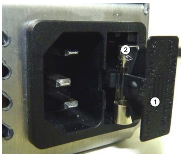
Figura 86 – Entrada do Fusível (1) & Fusível (2)
