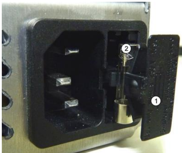
Figura 85 – Entrada do Fusível (1) & Fusível (2)
